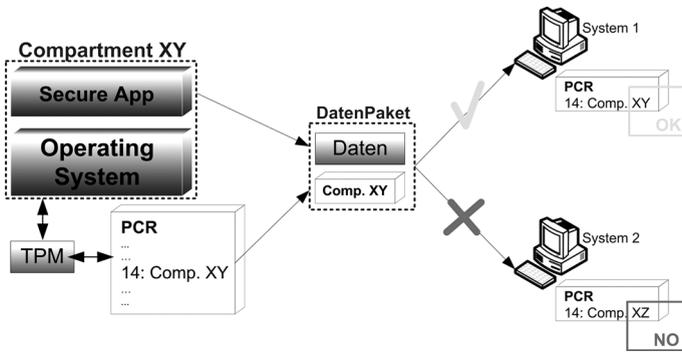
Abbildung 2: Der prinzipielle Vorgang beim sealing
